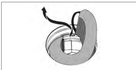
Abb. 7.6 Aktivkohlefilter aus der Einströmöffnung entnehmen
